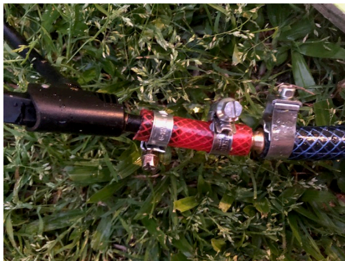
Foto 7 B: Plataforma a base de manguera con armazón de caños. Vista lateral; detalle del enganche al inflador o compresor.
