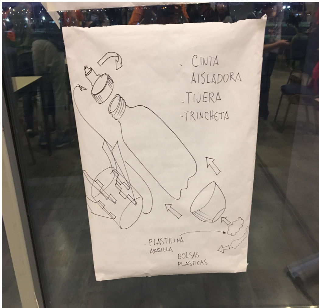
Foto 6: Despiece y ensamblado de la ojiva, la base y la tobera en el fuselaje.
