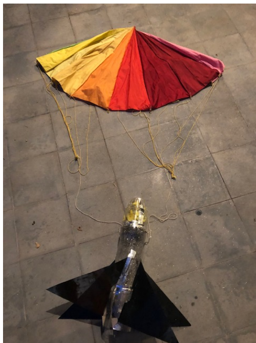
Foto 8: Paracaídas construido con tela de paraguas y piolín; detalle de mosquetones giratorios de pesca para enganche al cohete.
